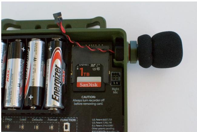
4. Gire o microfone no sentido horário para parafusá-lo na porca interna. Certifique-se de que os fios de conexão estejam girando livremente conforme o microfone é girado. Certifique-se de que a rosca esteja alinhada corretamente. Aperte ligeiramente com um alicate ou uma chave. Não aperte demais.
