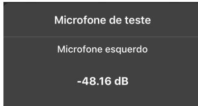
A sensibilidade do microfone acústico pode ser medida para testar sua funcionalidade. A calibração do microfone acústico é filtrada em banda a 1 kHz e é projetada para ser usada com um calibrador de microfone padrão de terceiros.
