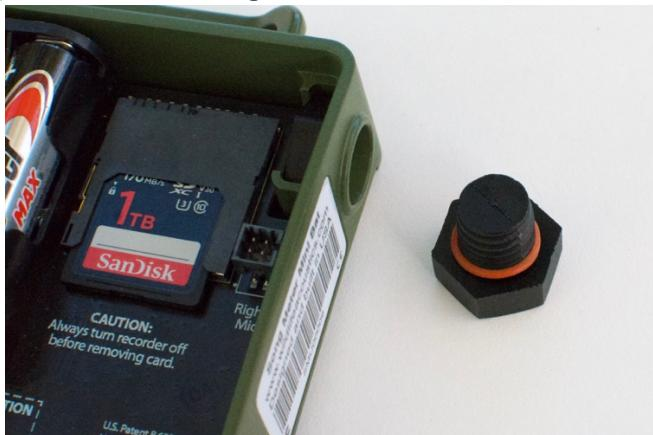
3. Passe o conector de fio do segundo microfone pelo orifício. Não conecte o fio à placa de circuito ainda.
