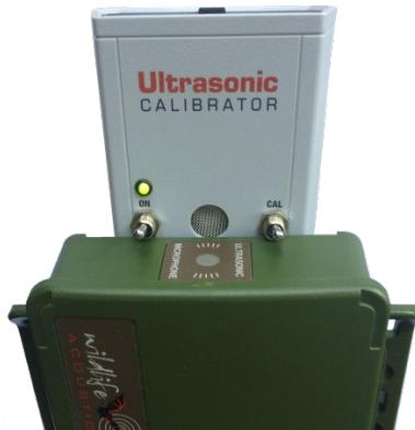
5. Observe o nível de dB na janela Testar microfone do aplicativo. Se o valor for maior (menos negativo) do que -32 dB, o microfone foi aprovado e está pronto para uso. Se o valor for menor (mais negativo), o microfone perdeu parte ou toda a sensibilidade e deverá ser substituído. Por exemplo, um valor de -40 dB significa que o microfone perdeu sensibilidade, enquanto um valor de -30 dB significa que o microfone foi aprovado.
