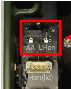
Conexão da fonte de alimentação do conector de 3 pinos com o jumper instalado na configuração padrão para usar baterias AA
