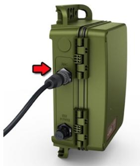
3. Alinhe e conecte o cabo ao conector **MIC**.
