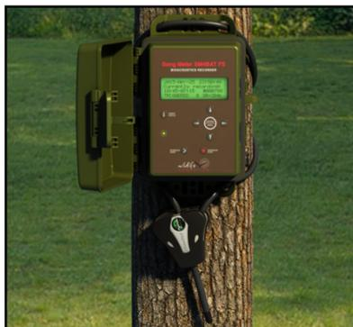
**NOTA:** não monte o gravador usando um cabo de trava ou outras cordas não-flexíveis em uma árvore em crescimento. O crescimento em circunferência pode fazer o cabo torcer ou quebrar o suporte de montagem do gravador. A árvore também não vai gostar.
